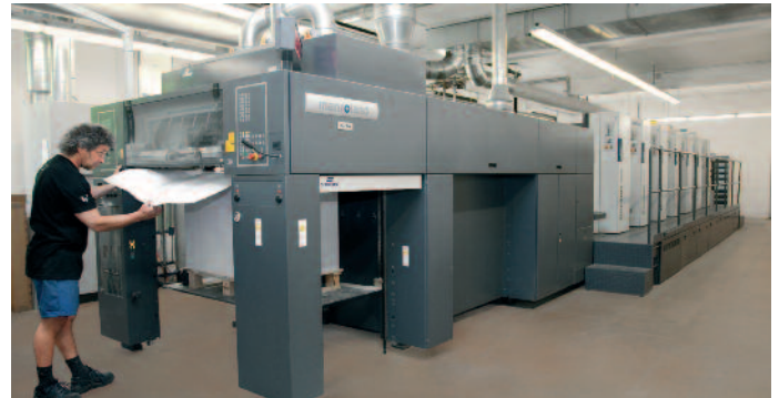
Novum für die Schweiz: Auf der Roland 700 HiPrint kommt erstmals das Farbmess- und -regelsystem InlineColorPilot zum Einsatz.
